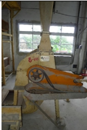
圖 8-1- 13 屏東菸葉廠除骨機皮帶與保護罩 (2015 年本研究拍攝)
