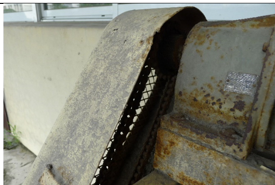
圖 8-1- 16 屏東菸葉廠廢料收集機鍊條與保護罩 (2015 年本研究拍攝)
