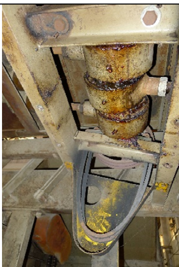
圖 8-1- 15 屏東菸葉廠菸葉切尖機鍊條與保護罩 (2015 年本研究拍攝)
