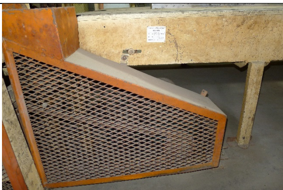
圖 8-1- 15 屏東菸葉廠菸葉切尖機鍊條與保護罩 (2015 年本研究拍攝)
