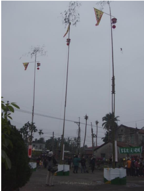
圖 4-11-1 2005 年麻竹連接方式搭十二米高炮竿底部用汽油桶當支架
