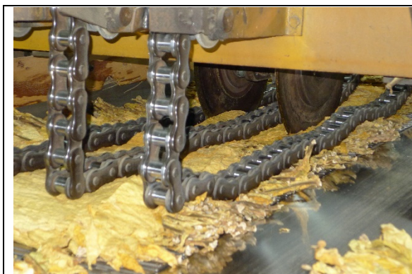
圖 6-1- 28 切尖機細部，鍊條壓住葉片後 由刀片進行切割（1） （2015 年林思玲拍攝）
