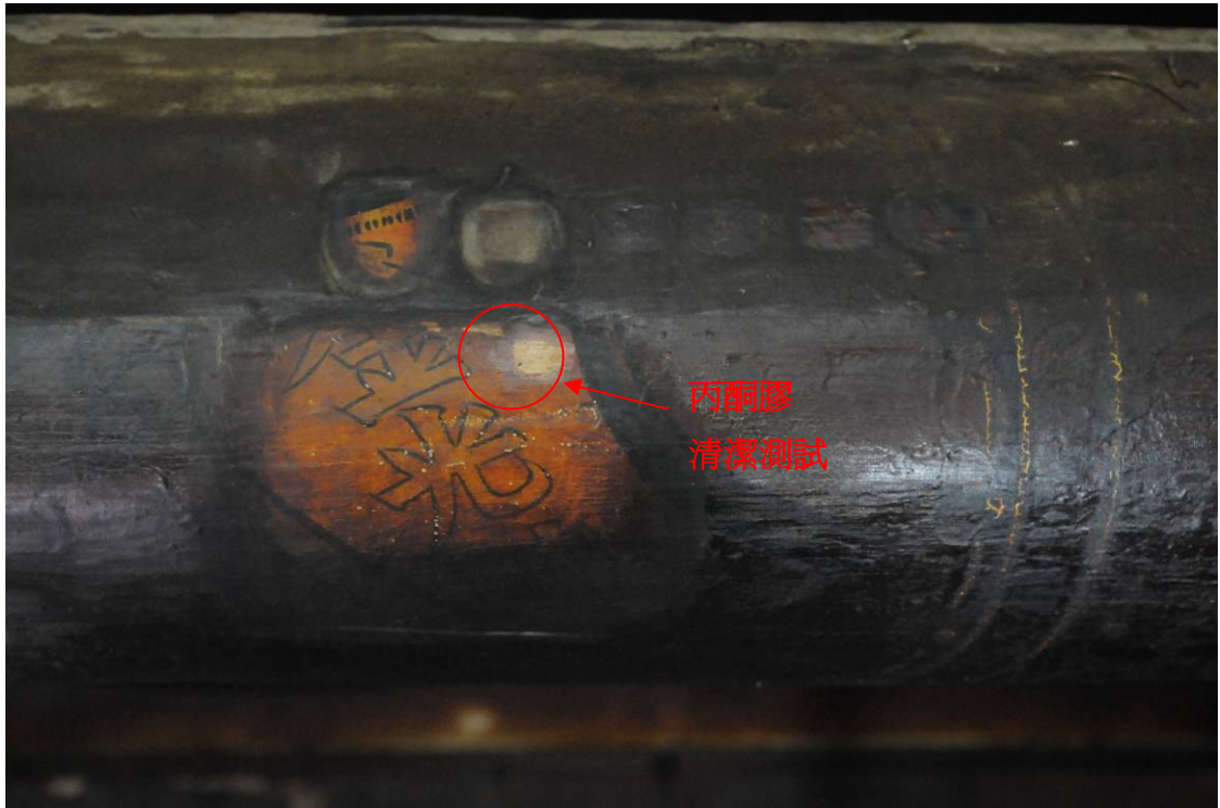
步驟九：以中性橄欖皂作清潔二次後，再以丙酮膠作小區塊清潔測試
