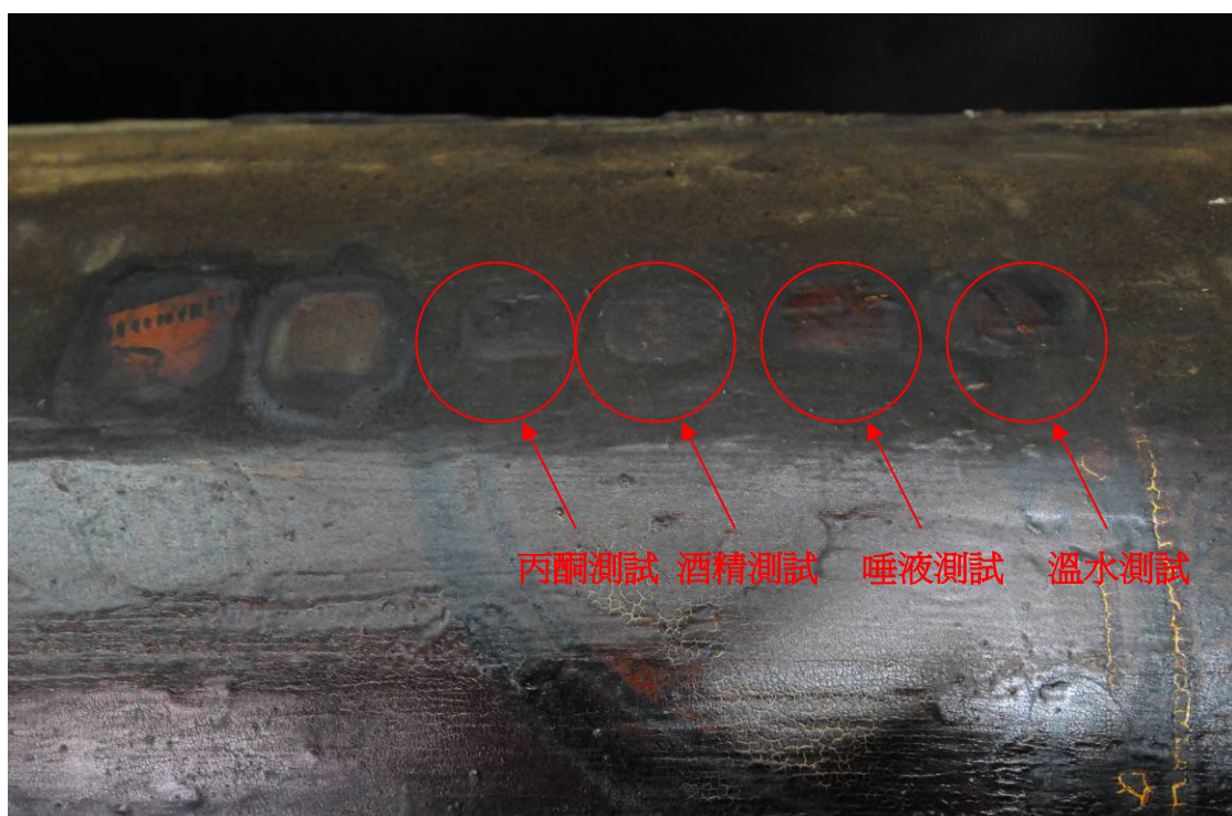
步驟五：以純丙酮作清潔測試
