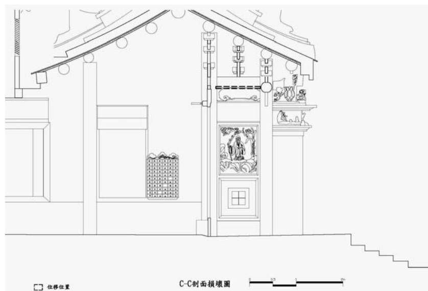
圖 5-1 C-C 剖面損壞圖（變形）
