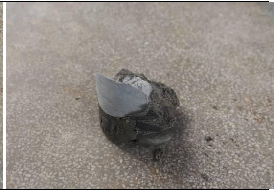
照片 4.4.6 混凝土鑽心試體在取出過程即碎裂，無法進行抗壓試驗（3F-1）。
