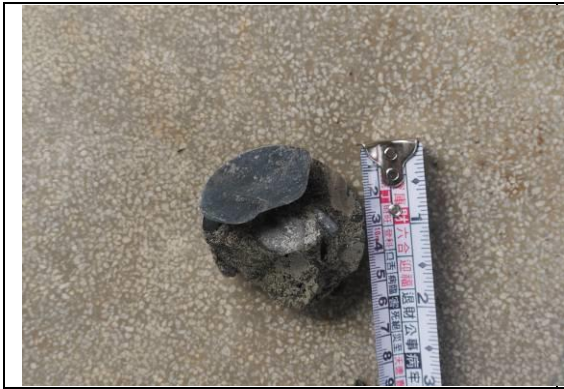
照片 4.4.5 混凝土鑽心試體在取出過程即碎裂，無法進行抗壓試驗（3F-1）。
