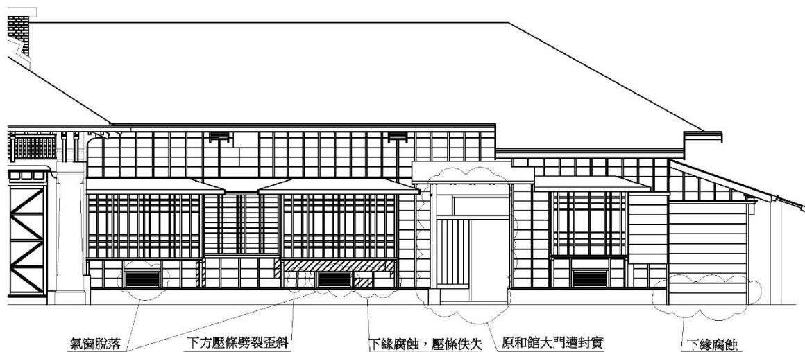
【圖 5-1】和館東面外觀損壞位置示意圖
