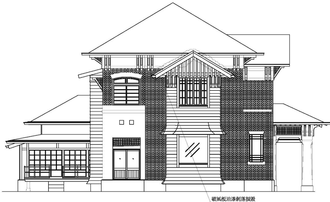
【圖 5-13】 洋館北面屋簷損壞位置示意圖
