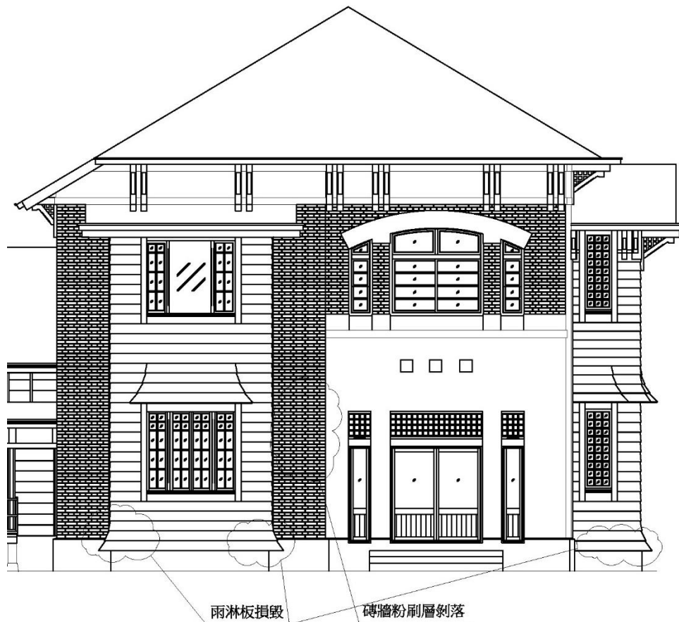
【圖 5-10】洋館西面外觀損壞位置示意圖
