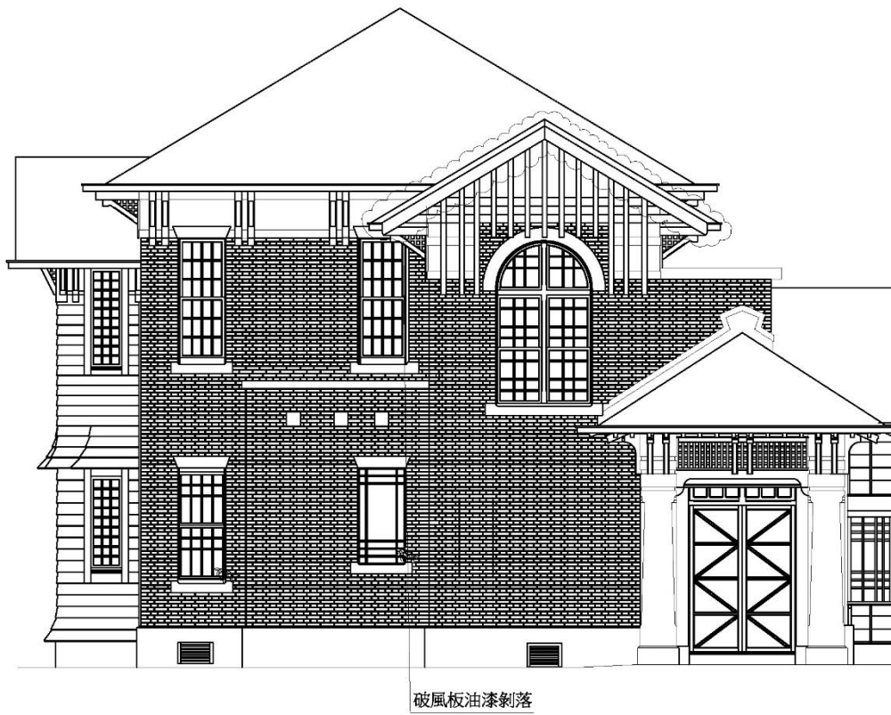
【圖 5-12】 洋館東面屋簷損壞位置示意圖
