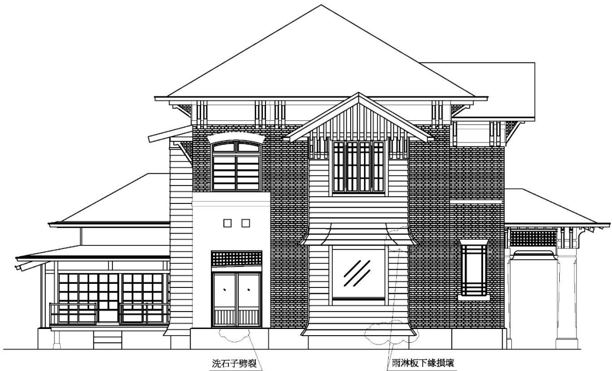
【圖 5-9】 洋館北面外觀損壞位置示意圖
