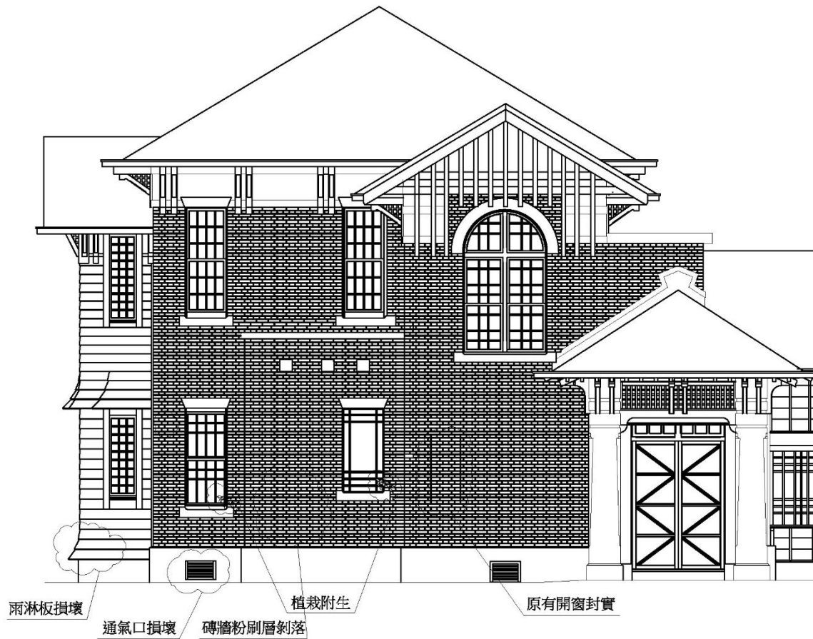
【圖 5-8】 洋館東面外觀損壞位置示意圖
