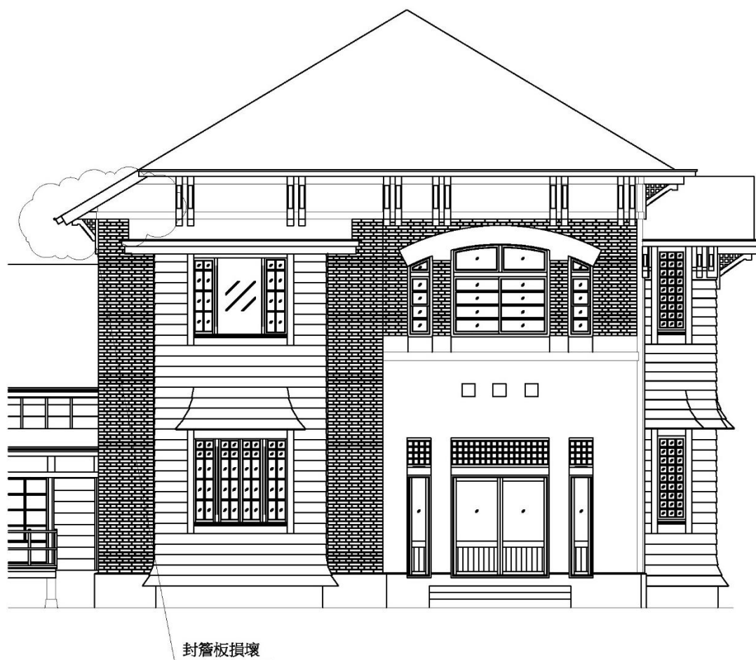
【圖 5-14】洋館西面屋簷損壞位置示意圖
